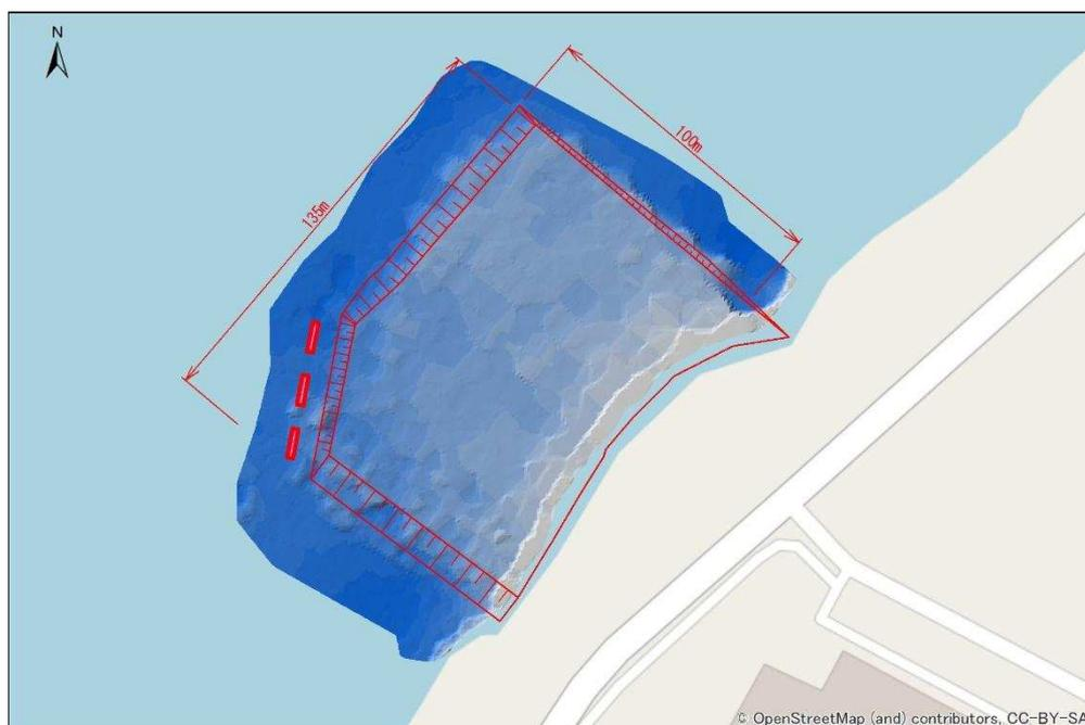
図 8 湖岸通り区 今回調査(H30. 3. 2)による 3D 地形図 (実線は完成時 (H29. 4 月時点) の形状)
